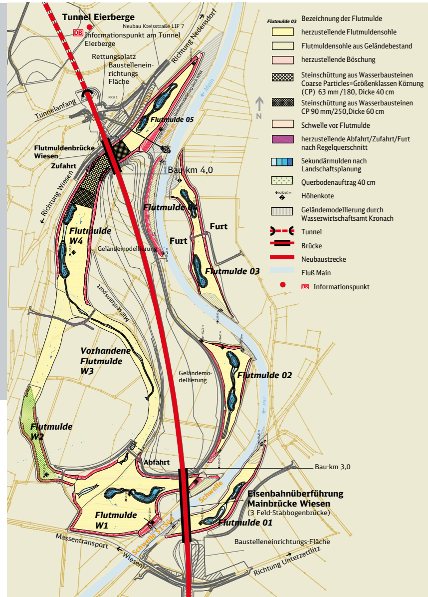
Der Entwurf der Flutmulden im Maintal nimmt die natürlich gewachsenen Formen der Mulden auf.
